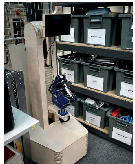
▲ Vaneri taipuu hyvin erilaisten koneiden rungoiksi, niin kuin tähän robottiin, jolla voidaan etänä neuvoa opiskelijoita JHC:n protopajassa.
